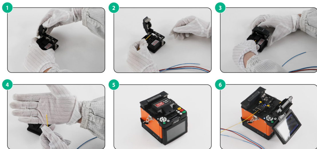
图C-10 光纤端面切割示意图
